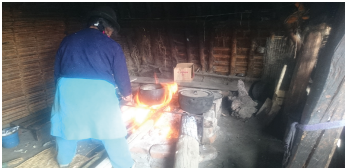
Figura 1-20 Foto con fogón central en la vivienda, el humo se evacúa por la parte superior de la forma piramidal de la vivienda. Autor: autora y equipo de apoyo
