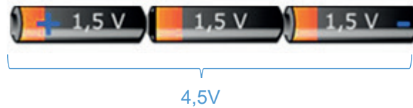
Figura 9. Baterías en serie.
