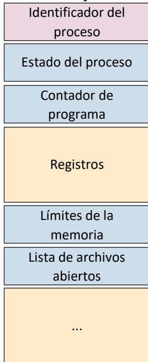
Figura 2.34: PCB - Bloque de Control de Procesos
