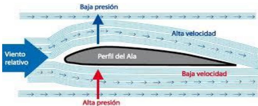
Figura 2.22. Efecto venturi sobre el ala de una aeronave. Vista de perfil
