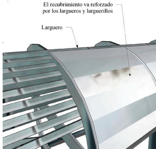
Figura 2.30. Fuselaje semimonocasco
