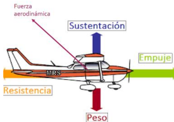
Figura 2.24. Fuerzas que actúan en una aeronave
